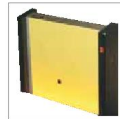
激光照射在黄色表面，在UV灯辅助照射下显示为黑色光斑
